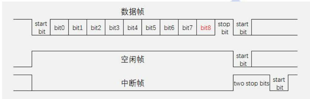
图 22-2 字长编程（以 9 位字长 M=01，1 个停止位 stop=0 为例）
