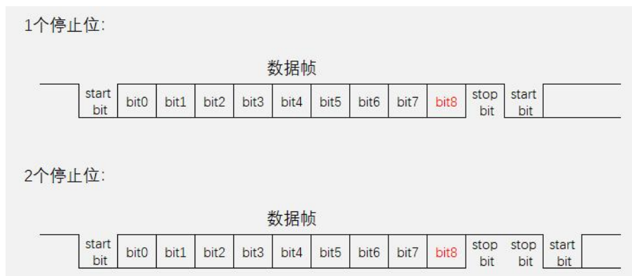
图 22-3 可配置的停止位（以 9 位字长 M=01 为例）
