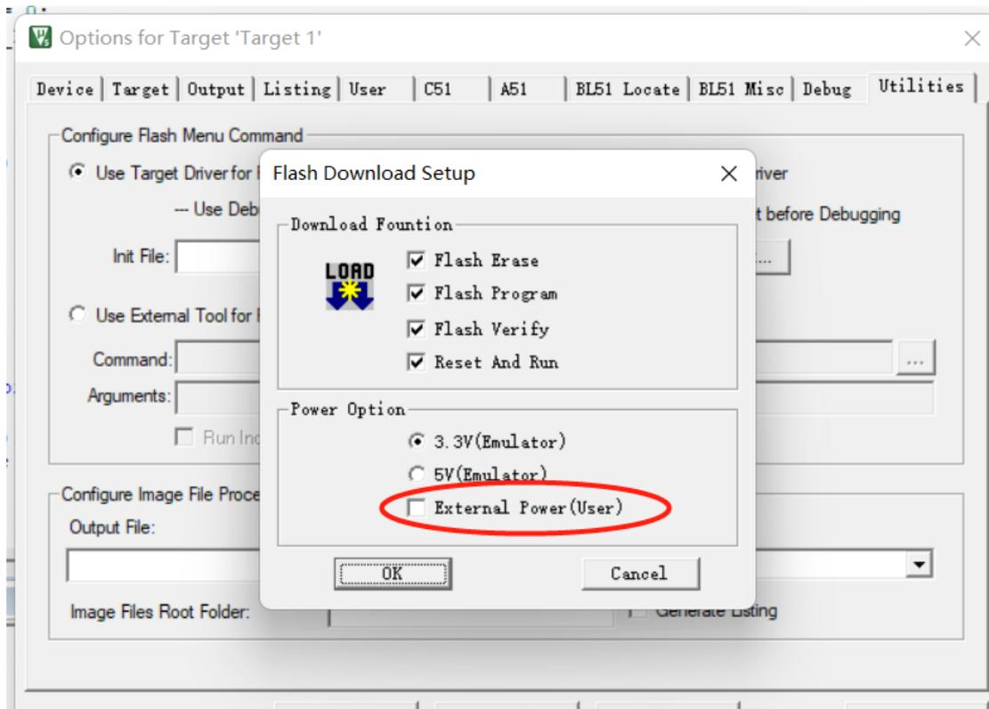
4) 电路板如果外部供电，离线下载时，需要在上位机-工具栏勾选使用外部电源进行下载配置
